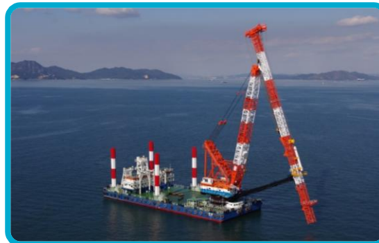
杭打ち兼起重機船「鶴隆」
