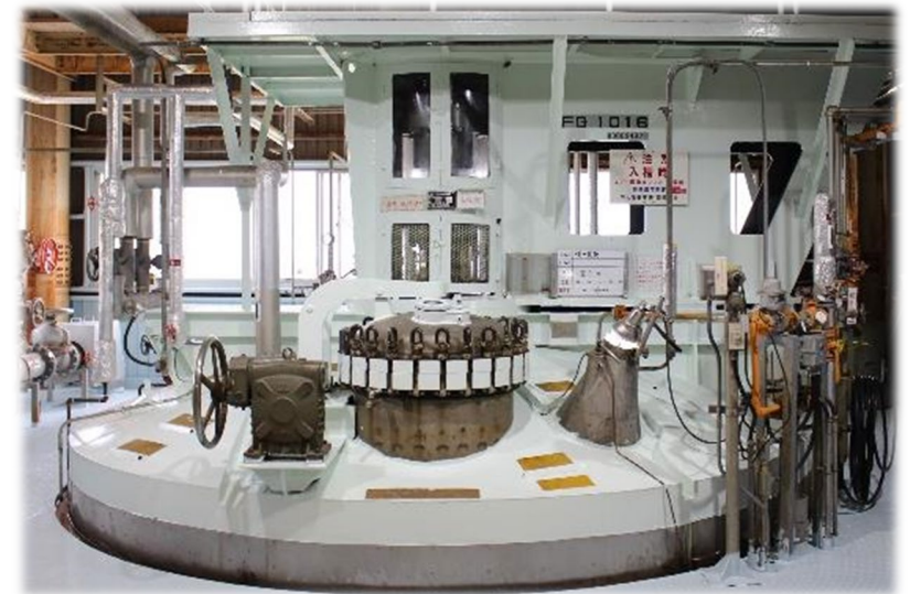
165kL発酵槽 (ペニシリン原料培養用)
