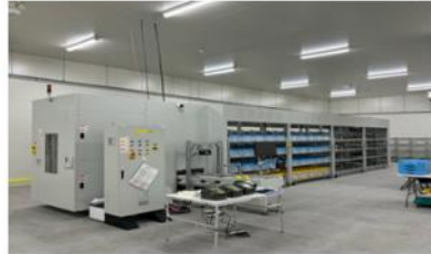
オムニソーター (立体型自動仕分ロボット)
